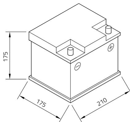
**Technologie** Geschlossene Kalzium-Batterie (Ca/Ca) | gefüllt und geladen | wartungsfrei
